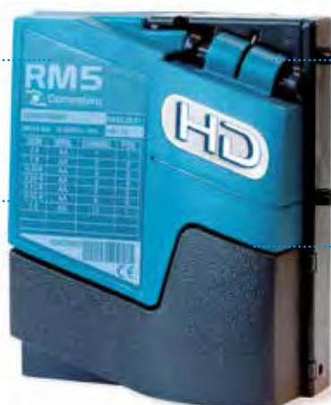
Avanzado sistema electrónico y mecánico antifraude: detección electrónica de hilos para recuperación fraudulenta de monedas, detección del sentido de movimiento de las monedas, 3 trampillas mecánicas, cuchilla cortahilos
